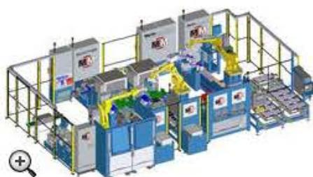
*Abschirmteile montiert die Anlage MCA211668 von MartinMechanic in 40 Sekunden, inklusiv dem Schweißvorgang auf der Schweißstation des Kunden. Bild: MartinMechanic*
